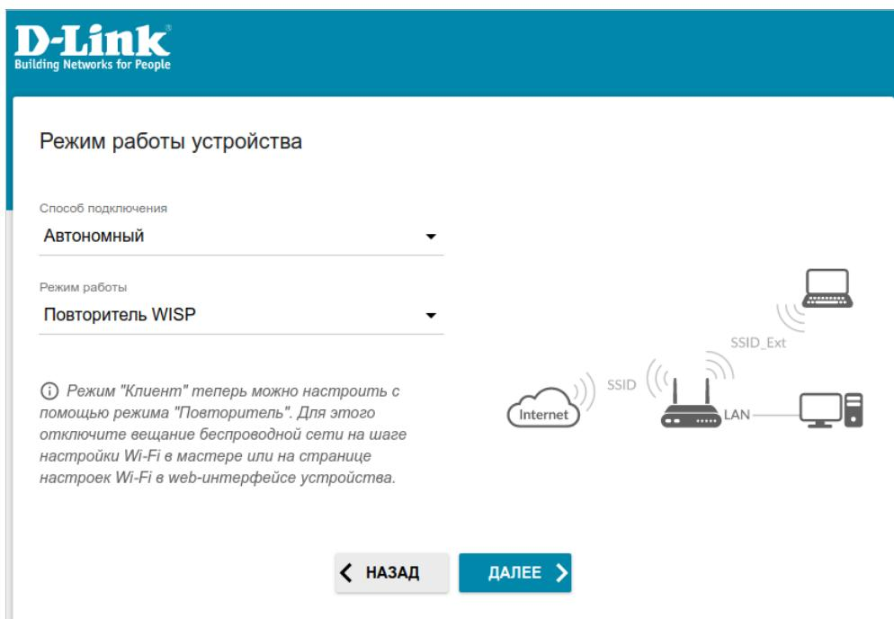
Рисунок 35. Выбор режима работы устройства. Режим Повторитель WISP.
