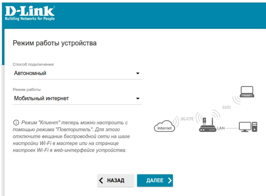
Рисунок 34. Выбор режима работы устройства. Режим **Мобильный интернет**.
