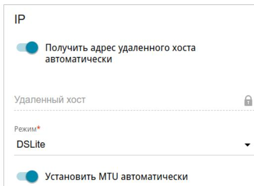
Рисунок 95. Страница добавления соединения типа **IP/IP6**. Раздел **IP**.
