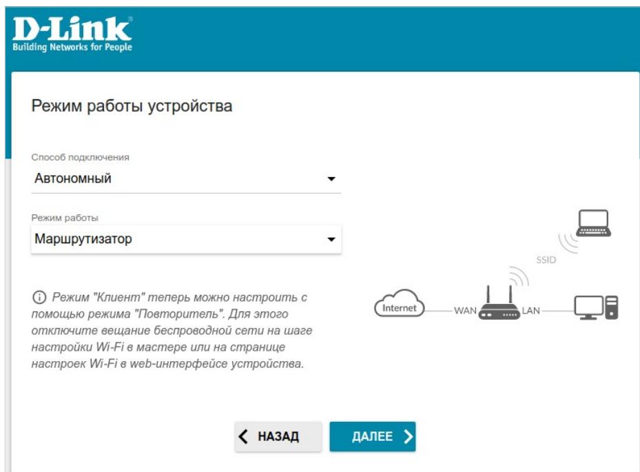
Рисунок 33. Выбор режима работы устройства. Режим **Маршрутизатор**.
