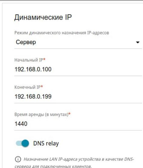
Рисунок 97. Настройка локального интерфейса. Вкладка **IPv4**. Раздел **Динамические IP**.
