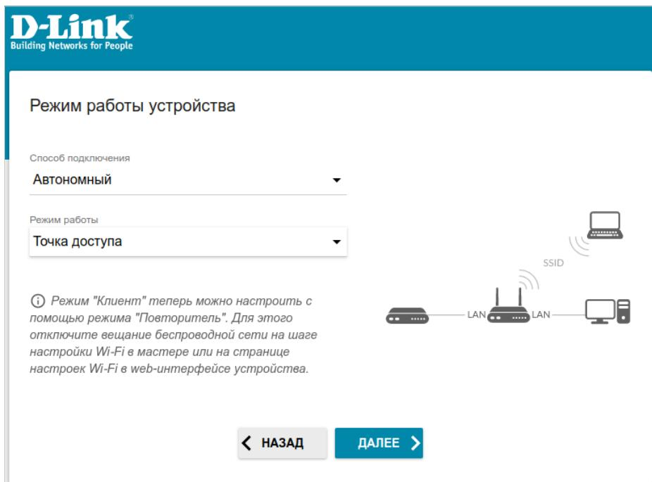
Рисунок 36. Выбор режима работы устройства. Режим **Точка доступа**.
