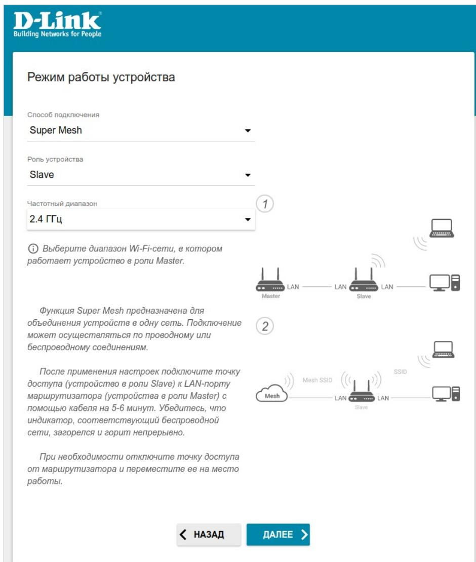
Рисунок 41. Настройка функции Super Mesh для зависимого устройства.
