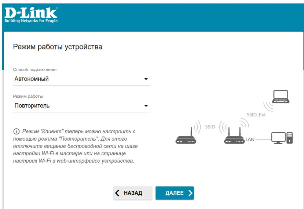
Рисунок 37. Выбор режима работы устройства. Режим **Повторитель**.
